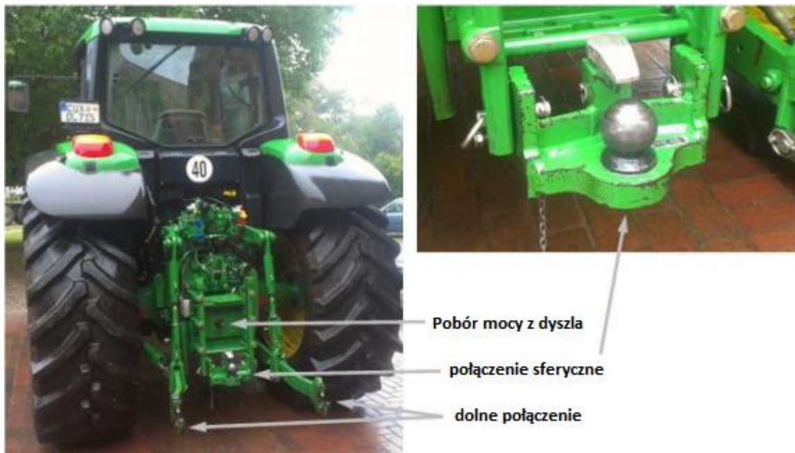
Rysunek 1: Sprzęg kulowy w ciągniku
